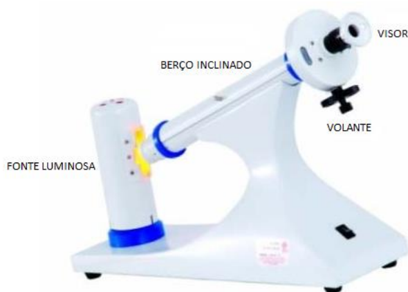
Figura 6- Fotografia de um polarímetro de disco
