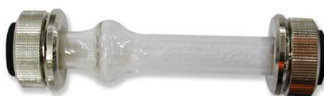
Figura 5: Imagem de uma ampola de polarimetria de 10 cm
