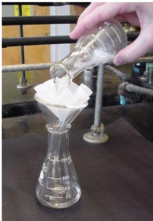
Figura 3. Filtração rápida de uma solução quente usando papel de filtro pregueado.
