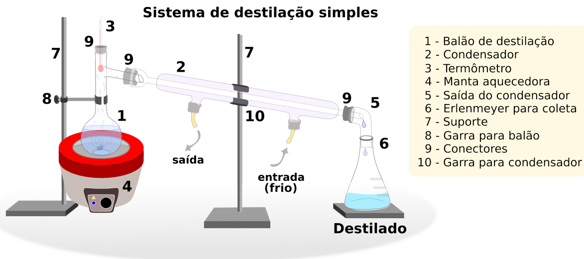
Figura 6.1: Sistema de destilação simples utilizando manta aquecedora como fonte de calor.
