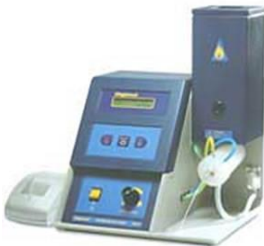
Figura 1: Fotômetro de chama
